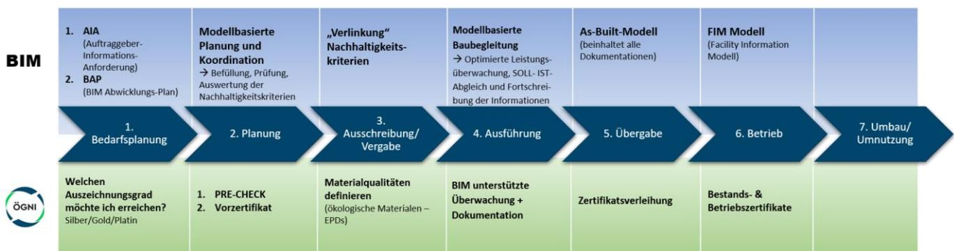
Abbildung 1: Leistungsphasen im Bauwesen und deren Bezug zu BIM und der Nachhaltigkeitsbewertung nach dem DGNB-System der ÖGNI.
